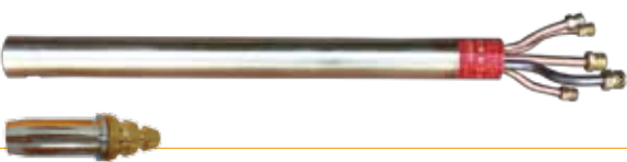
■ 500F平面连铸割炬 货号：5101080008 500F型等压式重型割炬为火焰切割机配套使用之割炬。本割炬系一种等压重 型水冷结构供机械控制使用的直式割炬，适用于钢坯连铸线上切割各种圆坯、 方坯、板坯。由于割炬体内有循环冷却水系统，故能长期在高温恶劣的工作 条件下连续正常使用。此外也可用于铸钢件浇冒口和钢坯炉料等气割加工。 500F型等压式重型割炬可根据切割钢材的不同厚度，以及不同类型燃气（乙炔、 焦炉煤气、天然气、液化石油气）来选择相应型号的割炬，以期达到各种 不同切割要求的加工。与SDS系列六角平面割炬配套使用。
