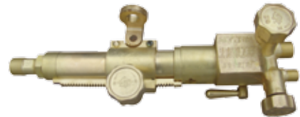
■ HY3 火焰加工器 货号：5116100006 本产品利用氧气和可燃气体混合燃烧产生高温火焰，对 金属和非金属表面加工和熔化的一种火焰加工设备。 规格：25~80#
